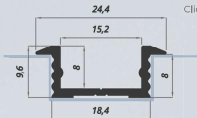
Profilo dissipatore led in alluminio da incasso
