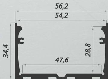
Profilo dissipatore led in alluminio
