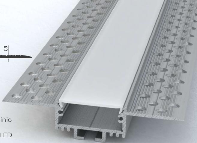
Profilo dissipatore led in alluminio per cartongesso (Consigliato l'utilizzo con strip LED fino a 35 W/m)
