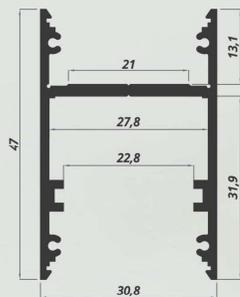
Profilo dissipatore led in alluminio
