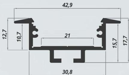
Profilo dissipatore led in alluminio
