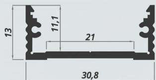
Profilo dissipatore led in alluminio
