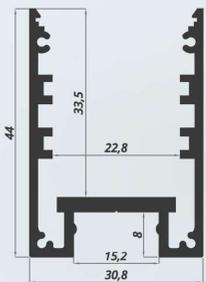
Profilo dissipatore led in alluminio
